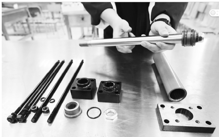
图3 液压元器件拆装展示
