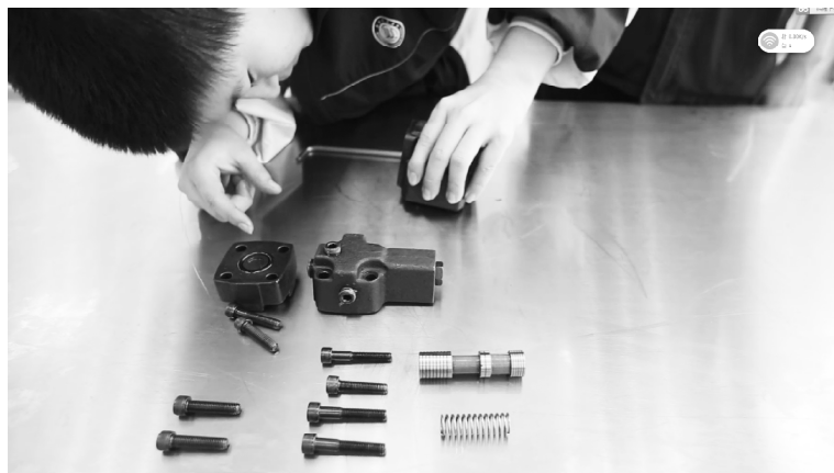
图 9 压力控制阀拆装实训微课展示
